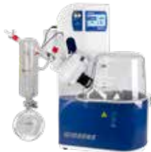
Strike 285 M2/M5 – модель с вертикальным нисходящим конденсатором
